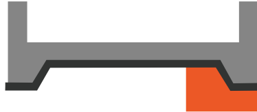
部分的な砕石置換
